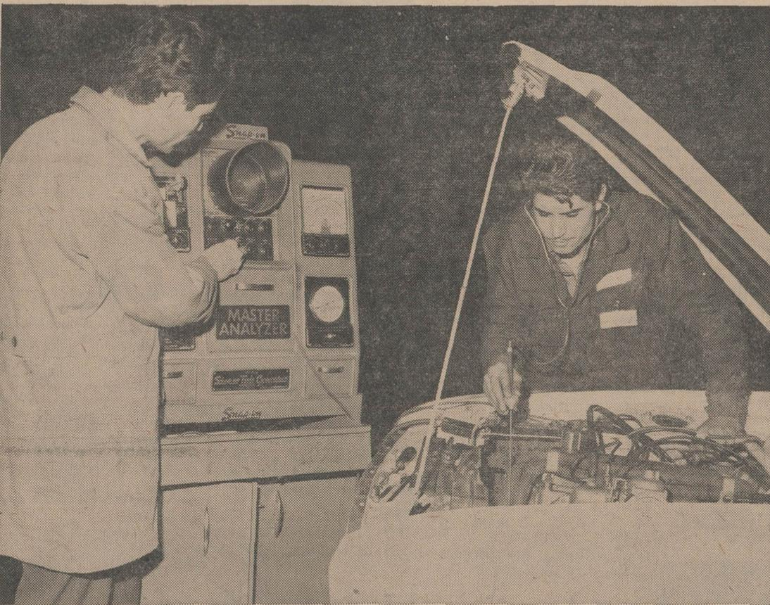
دستگاه ماستر آنالایزر که جزئیات طرز کار موتور را در صفحه ای مانند تلویزیون (باعلام الکترونیک) نشان میدهد و نمونه ای از دهها وسیله و ماشین آلات دقیق تعمیرگاه مرکزی پیکان است در گراور فوق نشان داده میشود.
